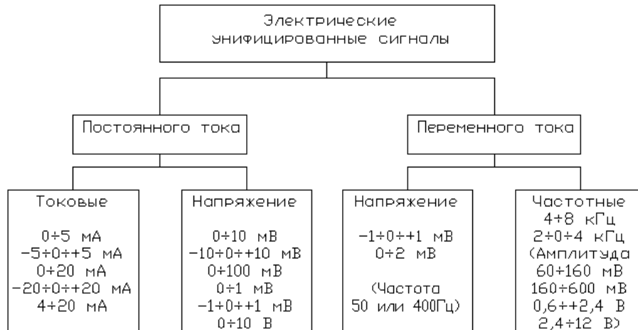
Рисунок 2.6 – Классификация основных унифицированных информационных сигналов электрической ветви приборов
